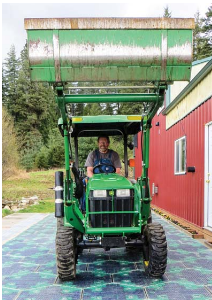
Próba stosowania Solar Roadways: Scott i Julie Brusaw testowali elementy we własnym domu z użyciem traktora (fot.: Scott and Julie Brusaw)
