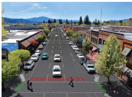
W mieście, na jezdni Solar Roadways oznakowanie świeci się i może też ostrzegać przed zagrożeniami lub pieszymi (fot.: Scott and Julie Brusaw)
